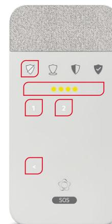
Se, dopo aver disattivato l'allarme, le quattro spie centrali si illuminano di giallo, vuol dire che è stato rilevato uno scatto di allarme mentre l'allarme era attivo.
