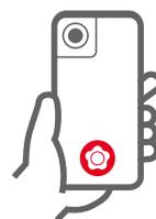
Assolve la stessa funzione delle Chiavi Magnetiche. Deve essere **posizionato nella parte bassa del retro del cellulare** per non interferire con l'antenna del telefono, **sopra la custodia di protezione**. Dall'app My Verisure Italia, potrai assegnare a ogni utente lo Smart Sticker in alternativa alla Chiave Intelligente.
