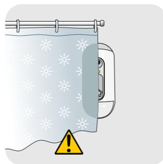
Assicurati di **non coprire la visuale delle Fotocamere e dei Sensori Perimetrali** con tende, mobili o qualsiasi altro materiale (ad esempio attrezzature da magazzino o pacchi).
