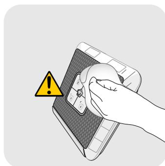
Per **spolverare i dispositivi**, non utilizzare detersivi ma **solo un panno asciutto** da passare con delicatezza sui sensori.
